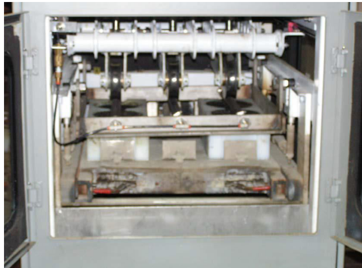
Figure 3.5. AASHTO TP63 setup
